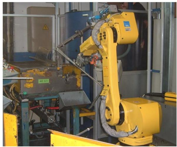
Robot trabajando con pinza neumática para tubo largo (mano intercambiable)
