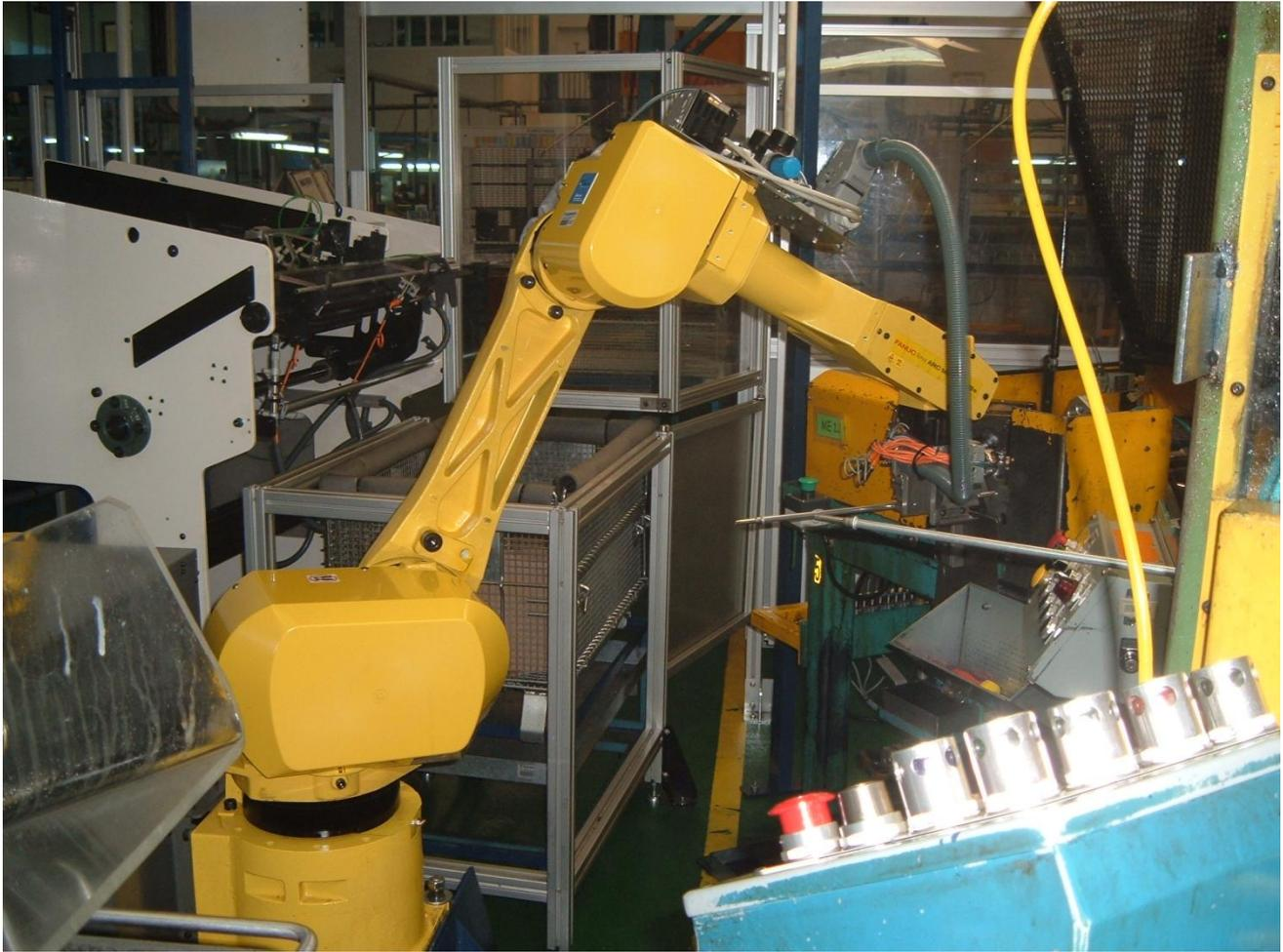
Detalle robot posicionando pieza en máquina colocación capochón
