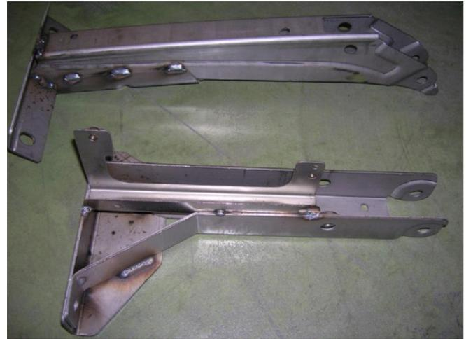
Detalle de piezas a soldar en la célula
