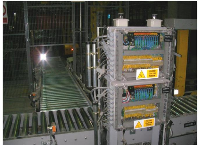
Detalle de instalación, caminos de rodillos entrada cajas a robots
