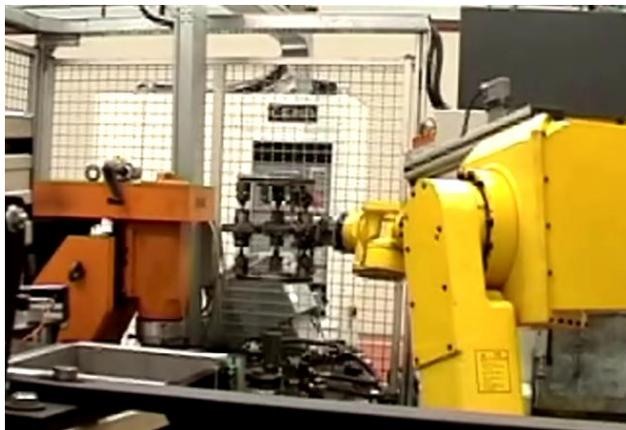
Carga y descarga de discos sobre Equilibradora
