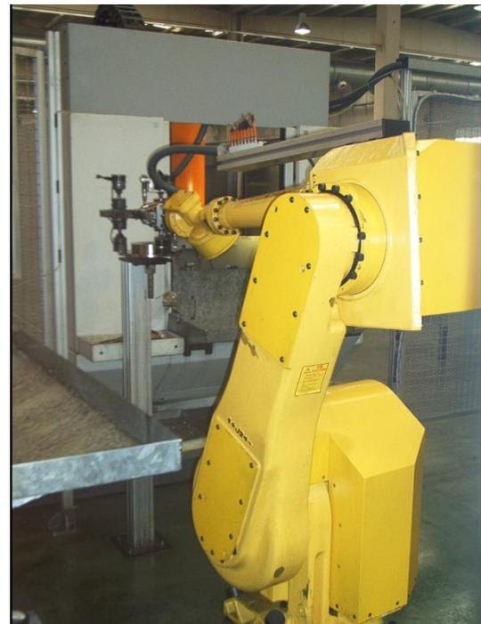
Robot posicionando pieza en taladro automático
