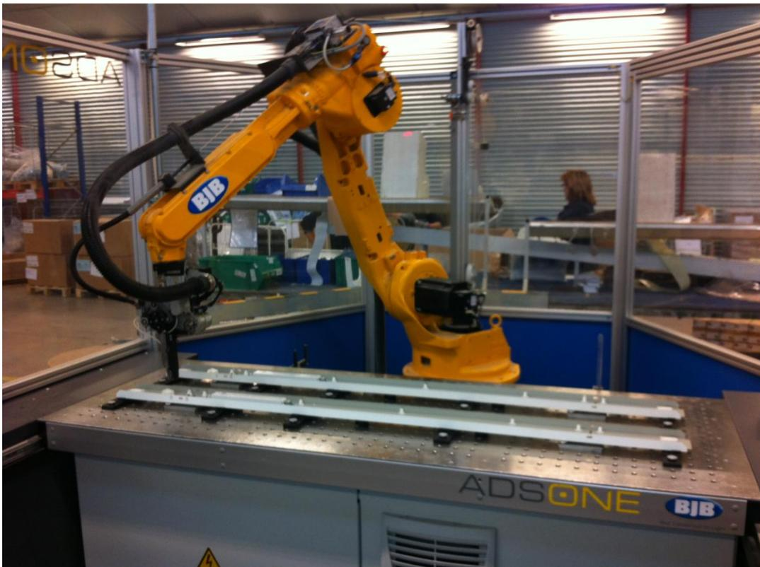
Robot cableando luminarias
