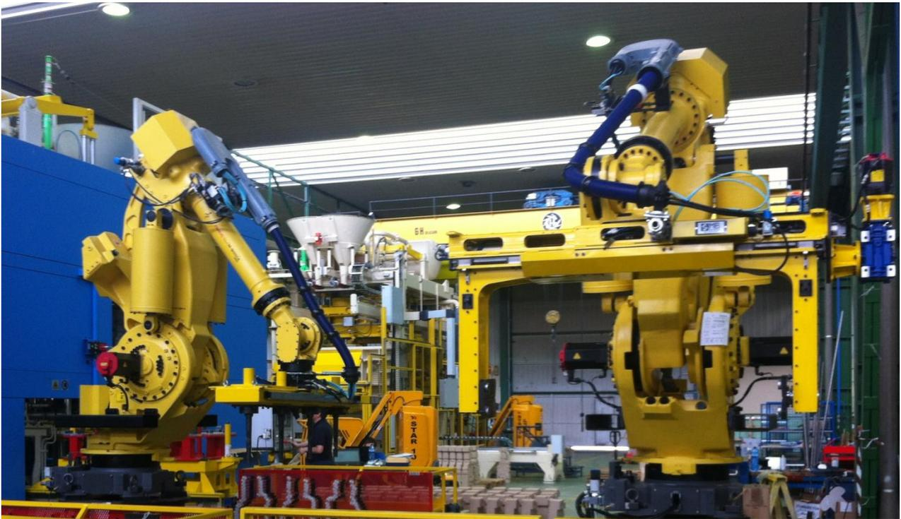
Vista instalación, robot de descarga y robot de apilado y ensamblado
